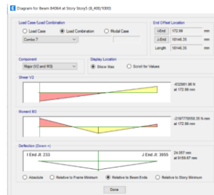
Gambar 13. Hasil analisis: momen lentur, gaya geser, lendutan akibat kombinasi beban terfaktor paling maksimum.
